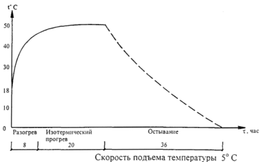
Рисунок 8 - График обогрева бетонной смеси
